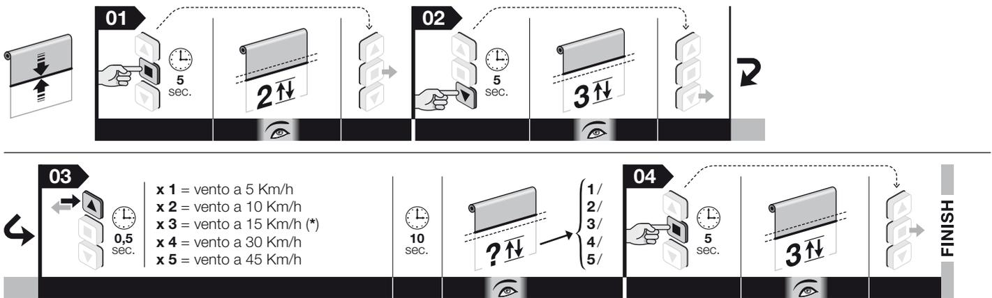
**Nota:** • Durante l'esecuzione della procedura, in qualunque momento è possibile annullarla mantenendo premuti contemporaneamente i tasti ■ e ▼ per 4 secondi. In alternativa non premere alcun tasto e attendere 60 secondi che il motore esegua 6 movimenti. • Se si utilizza un sensore dotato di "trimmer", occorre regolare la soglia direttamente sul sensore, facendo riferimento alle sue istruzioni.
