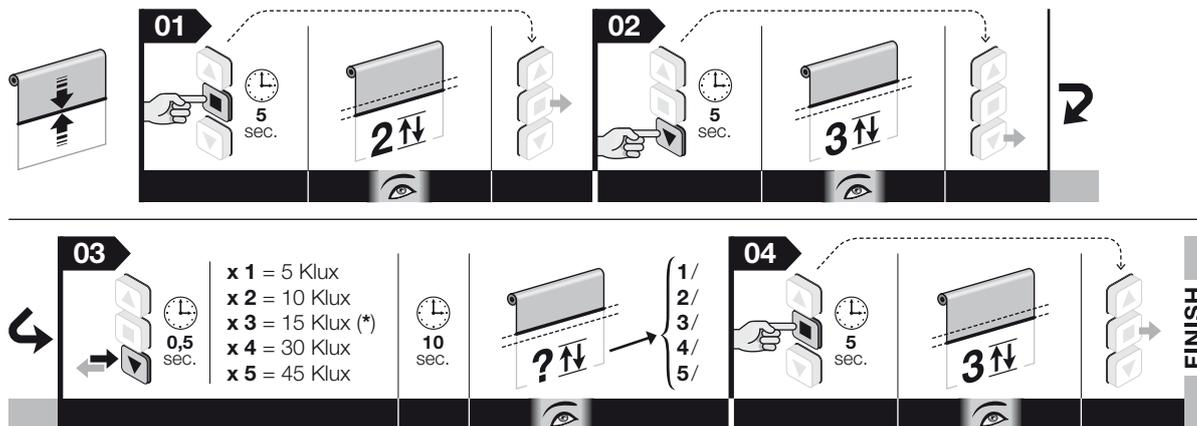
**Nota:** • Durante l'esecuzione della procedura, in qualunque momento è possibile annullarla mantenendo premuti contemporaneamente i tasti **■** e **▼** per 4 secondi. In alternativa non premere alcun tasto e attendere 60 secondi che il motore esegua 6 movimenti. • Se si utilizza un sensore dotato di "trimmer", occorre regolare la soglia direttamente sul sensore, facendo riferimento alle sue istruzioni.
