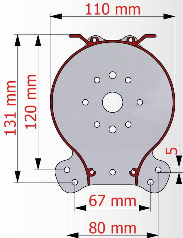
**Disegno tecnico quotato per posizione installazione tenda:**
