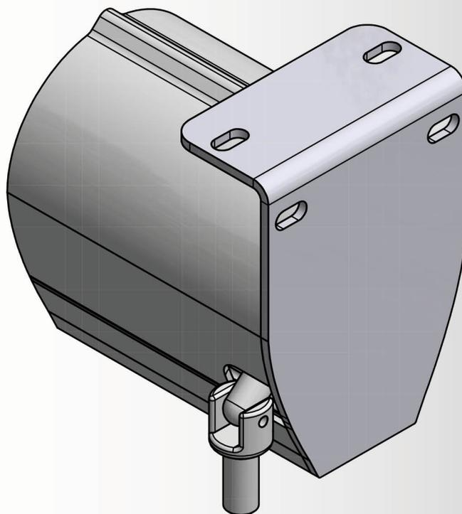
**Vista laterale con staffa installazione soffitto inclinato / parete:**
